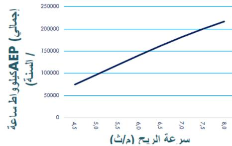
تعتمد البيانات الموضحة في الرسوم البيانية على الشروط القياسية باستخدام: k (shape parameter, Weibull slope) equal to 1,6 and air density in standard conditions (equal to 1,225 kg/m<sup>3</sup>).
