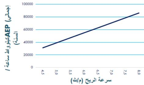
تعتمد البيانات الموضحة في الرسوم البيانية على الشروط القياسية باستثناء: k (shape parameter, Weibull slope) equal to 1,6 and air density in standard conditions (equal to 1,225 Kg/m³).
